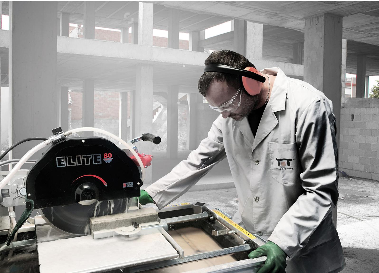
Die Tischsäge ist für alle Schneidarbeiten im Nass und Trockenschnitt mit Diamant-trennscheiben. Optimal für den flexiblen Baustelleneinsatz, da die Maschine von einer Person transportiert werden kann. Laserlinel und Winkelanschlag machen präzise Schnitte möglich. Einsatzbereiche im Gartenlandschaftsbau, Tiefbau, Hochbau, Industrie, Handel usw. möglich.
